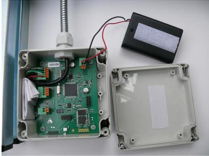
**Bild: 2 - Batteriefach von Klettband gelöst**
